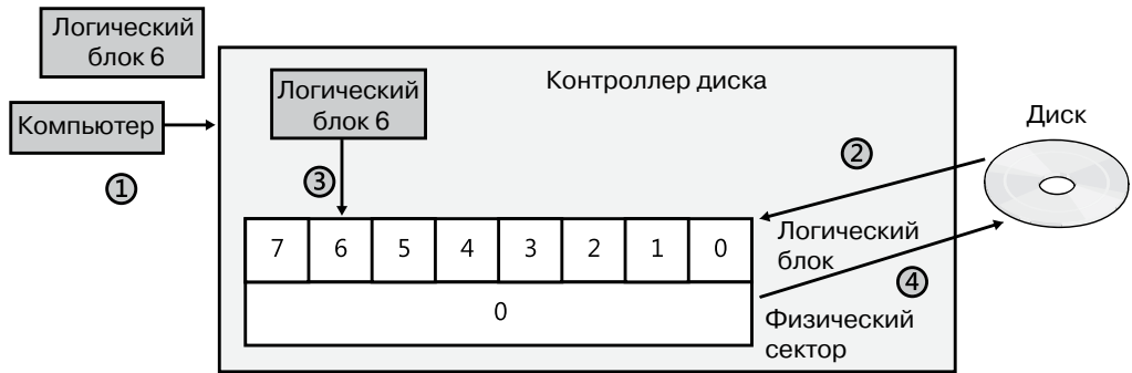
Рис. 9.2. Операция «чтение-изменение-запись» в режиме эмуляции 512e
