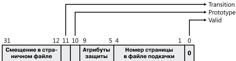
Рис. 10.26. Запись таблицы страниц, представляющая страницу в файле подкачки
