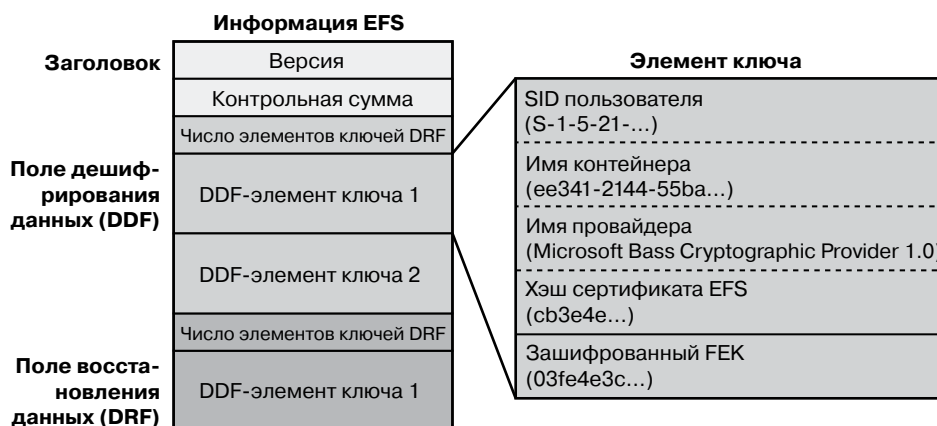
Рис. 12.63. Форматы EFS-информации и элементов ключа
